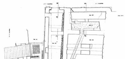
tamponate le porte lungo le pareti N e S e la volta fu abbassata con la creazione di una serie di sottarchi probabilmente costruiti per rinforzo, in occasione di nuovi carichi nei piani soprastanti.
